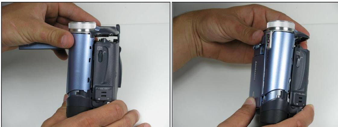
⚠ Retirez très soigneusement le capot avant du corps principal du caméscope.
