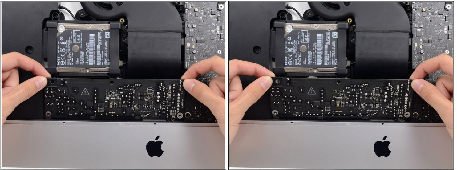
⚠ Lorsque vous manipulez le bloc d'alimentation, veillez à ne pas toucher les pattes des condensateurs ni les soudures exposées à l'arrière du bloc d'alimentation. Tenez-le toujours par les côtés.
