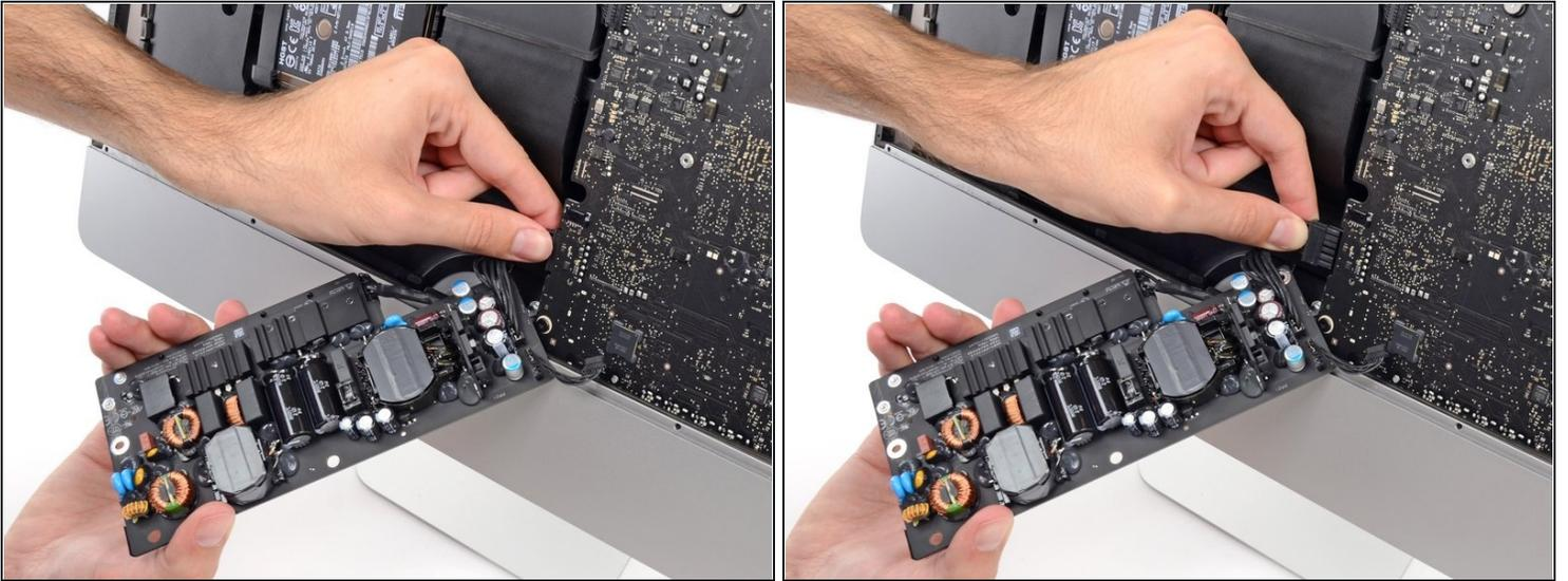
**⚠** Veillez à ne pas toucher les pattes des condensateurs ni les soudures exposées à l'arrière du bloc d'alimentation. Tenez-le toujours par les côtés.
