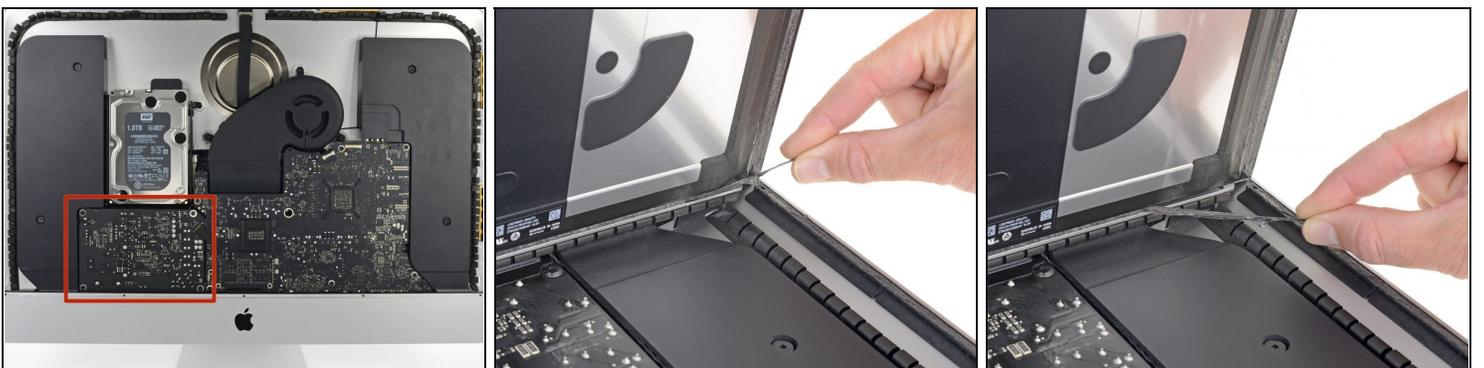
**⚠ Veillez à ne pas toucher les pattes des condensateurs ni les joints de soudure à découvert à l'arrière du bloc d'alimentation (dans l'encadré rouge).**
