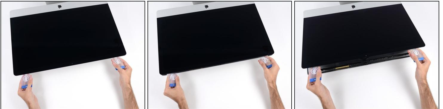
**⚠ Soulevez l'écran de quelques centimètres seulement, car il est encore relié à l'iMac par les nappes de données et d'alimentation.**
