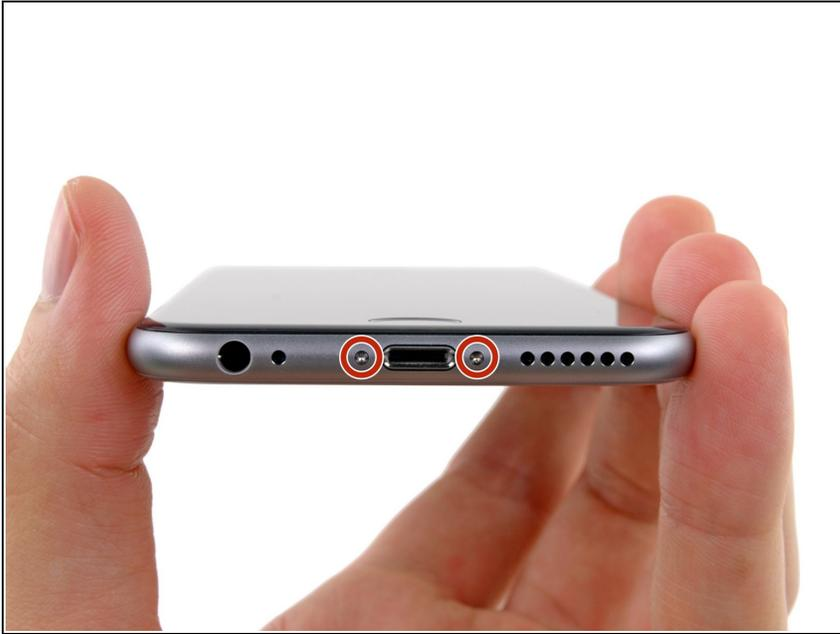
**⚠** Avant de désassembler votre iPhone, déchargez la batterie en dessous de 25%. Une batterie lithium ion chargée peut s'enflammer et/ou exploser si elle est percée accidentellement.
