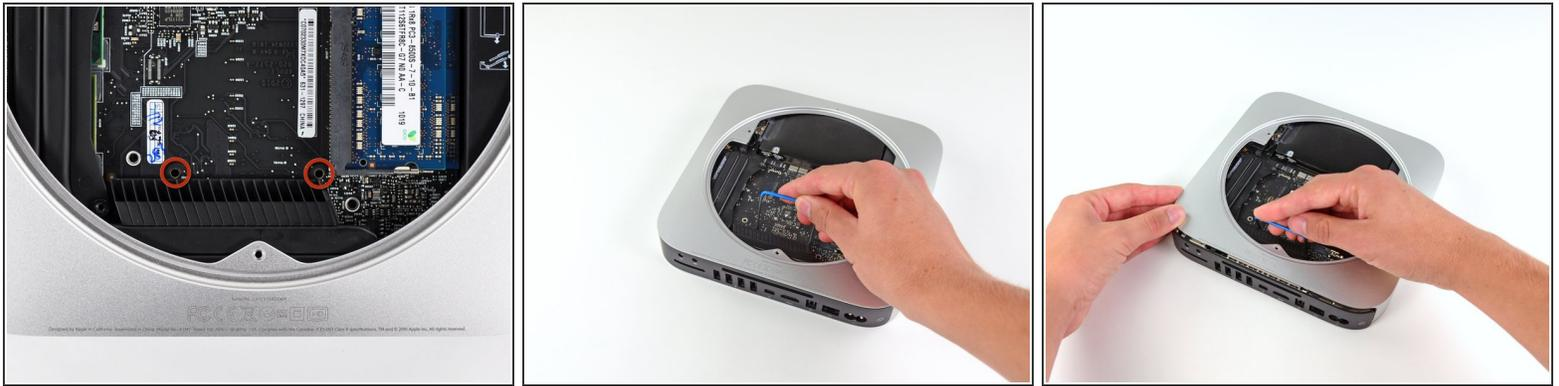
**i** Afin de dégager un espace suffisant pour retirer le disque dur, il est nécessaire de sortir légèrement la carte mère. À cet effet, vous devez insérer deux tiges cylindriques dans les orifices repérés en rouge.
