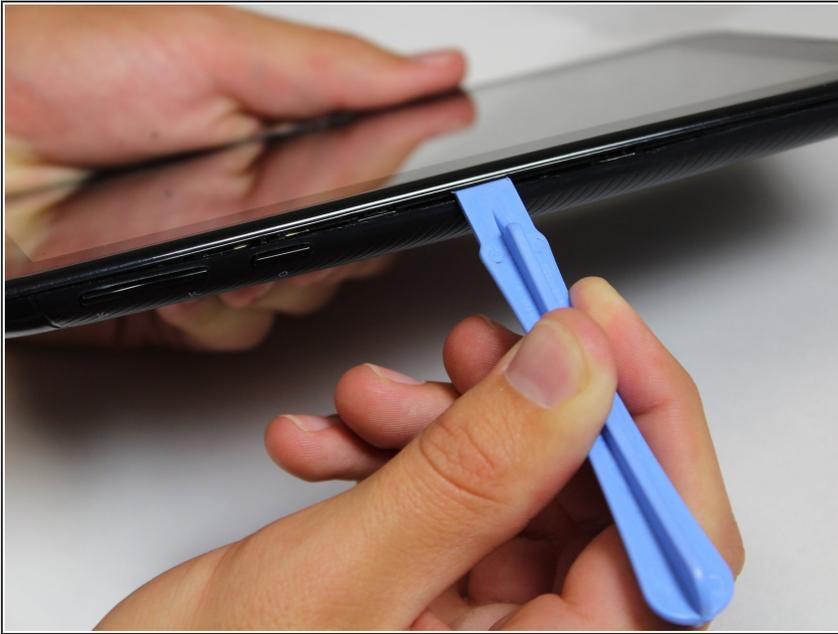
**⚠** Soyez prudent lorsque vous retirez le panneau arrière. L'enceinte est connectée aux panneaux avant et arrière et peut être retirée si vous ne soulevez pas doucement le panneau arrière.
