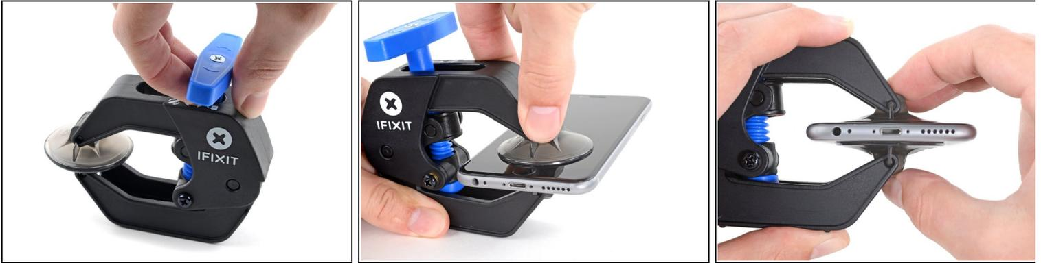
ⓘ Les deux étapes suivantes montrent comment utiliser l'Anti-Clamp, un outil conçu pour faciliter la procédure d'ouverture. **Si vous n'utilisez pas l'Anti-Clamp, sautez ces deux étapes pour une autre méthode.**
