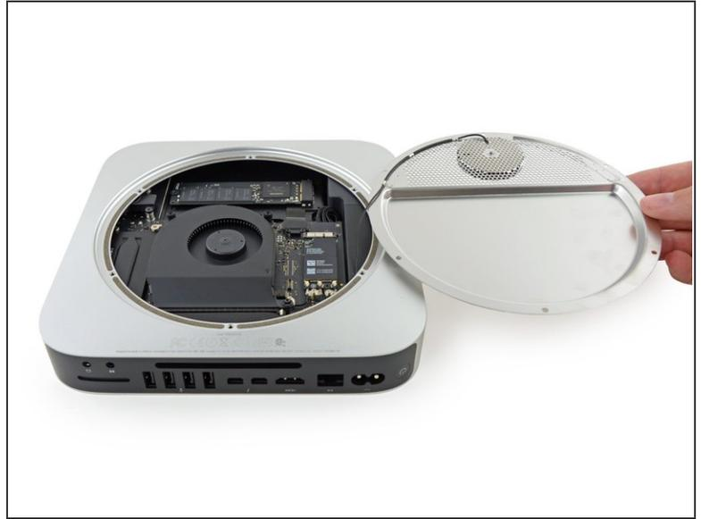
**!** Ne pas enlever complètement la plaque d'antenne; elle est toujours connecté au Mac mini par un câble d'antenne.
