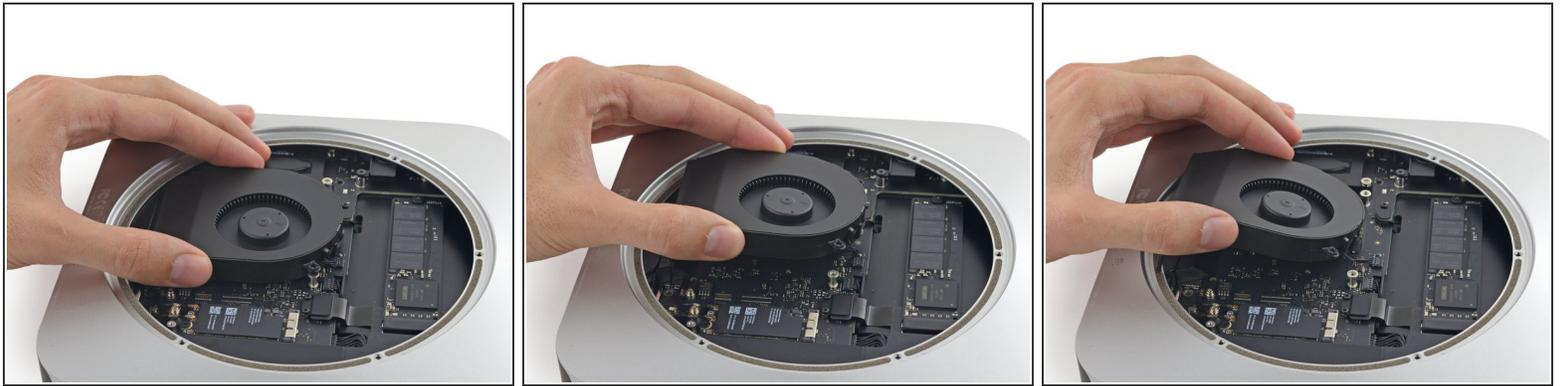
**i** Le connecteur du ventilateur est bloqué sous le bord du ventilateur, et ne peut pas être déconnecté tant que le ventilateur n'est pas déplacé.
