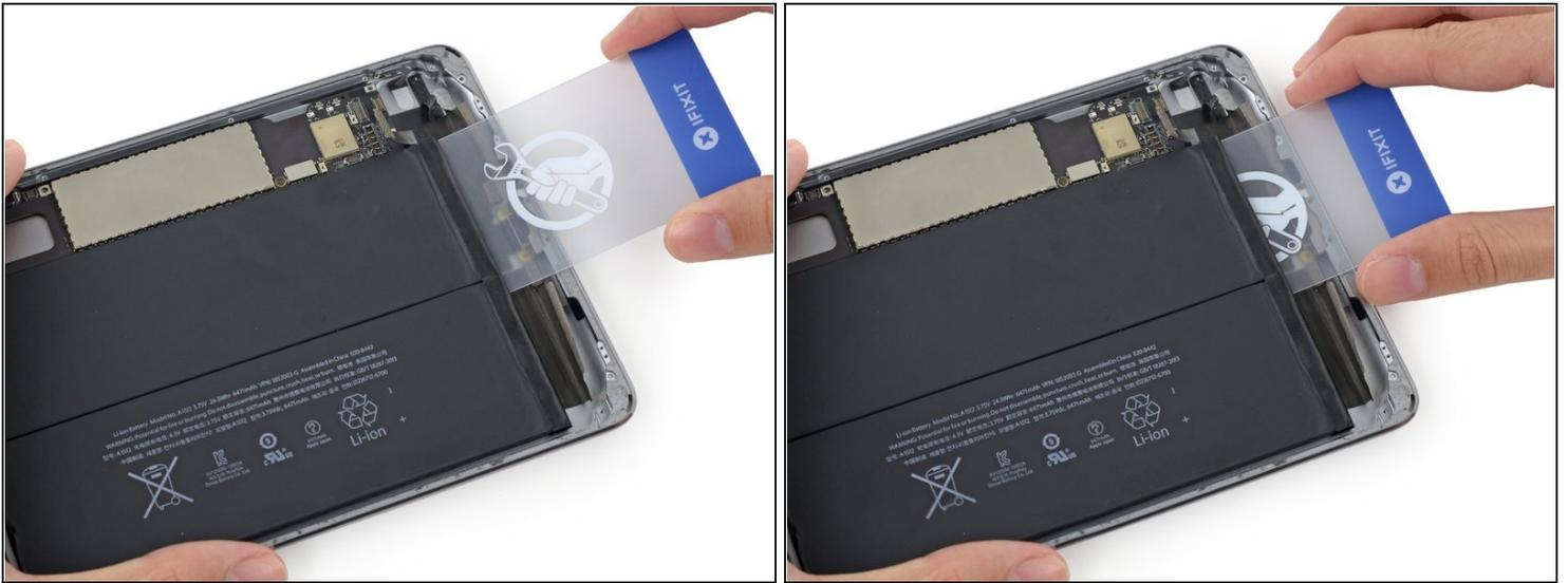
**⚠** Tout au long de la procédure suivante, vous allez glisser des fines cartes en plastique entre la batterie et la coque arrière de l'iPad pour décoller l'adhésif. Veillez à garder les cartes aussi plates que possible pour éviter de plier la batterie, ce qui pourrait l'endommager et laisser s'échapper des produits chimiques dangereux.
