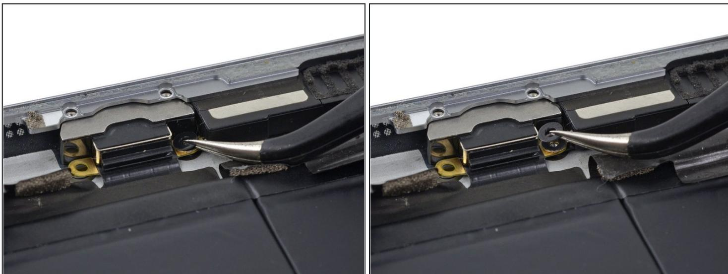
ⓘ La vis qui traverse le connecteur de charge Lightning a une petite rondelle reposant sur les contacts des haut-parleurs. Assurez-vous de ne pas la perdre.
