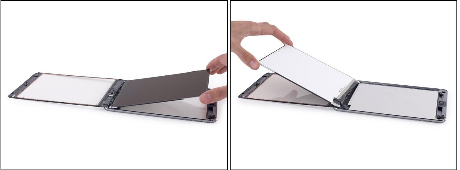
⚠ N'essayez pas d'enlever complètement l'écran LCD. Il est toujours connecté à l'iPad par plusieurs nappes du côté du bouton home. Soulevez du côté de la caméra frontale.
