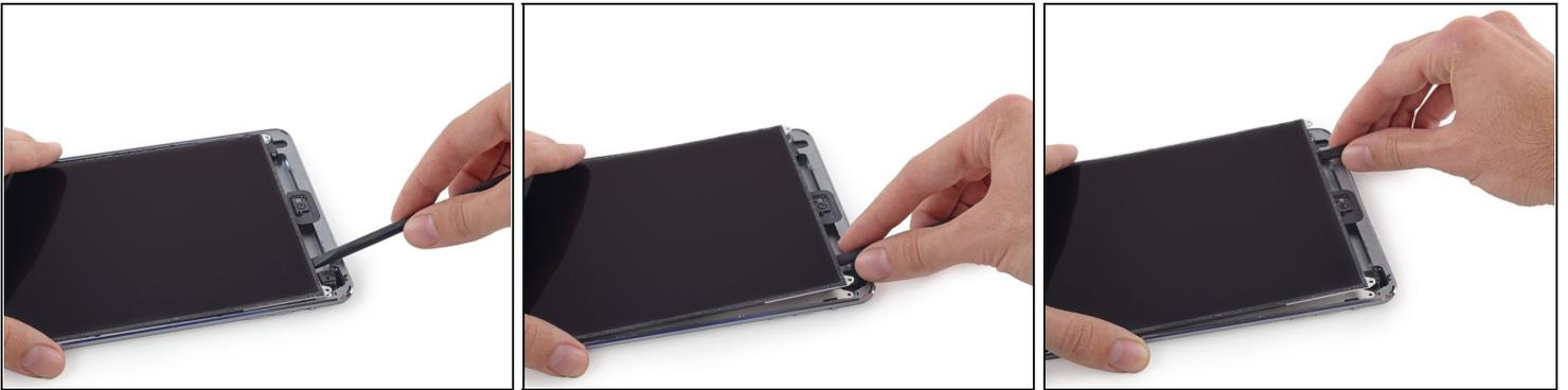
ⓘ L'écran LCD est fixé par un adhésif doux qui doit être décollé avant de séparer l'écran LCD de sa plaque de protection.
