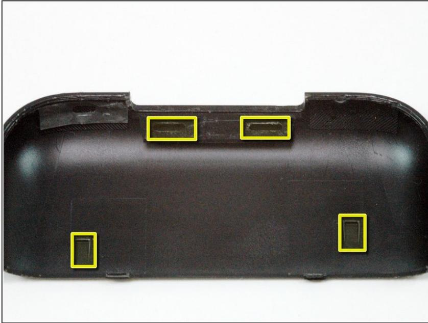
**i** Sur cette image on peut voir les deux languettes et les deux loquets situés sur l'envers du cache de l'antenne. Les deux languettes en haut de l'image doivent être poussées vers le cache noir pour les dégager.
