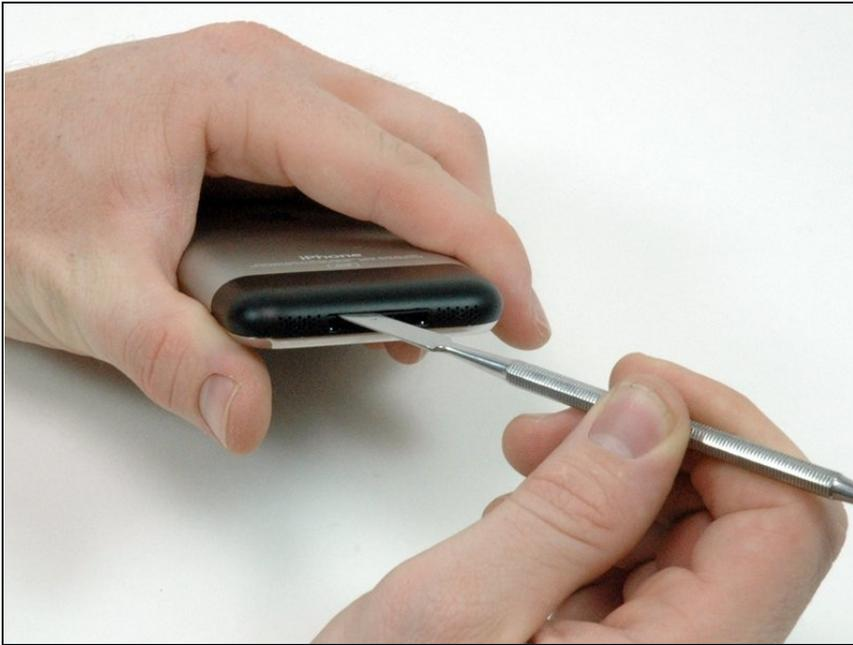
⚠ Veillez à insérer la spatule (spudger) en métal entre le connecteur de dock et le cache de l'antenne, et non pas dans le connecteur de dock même.
