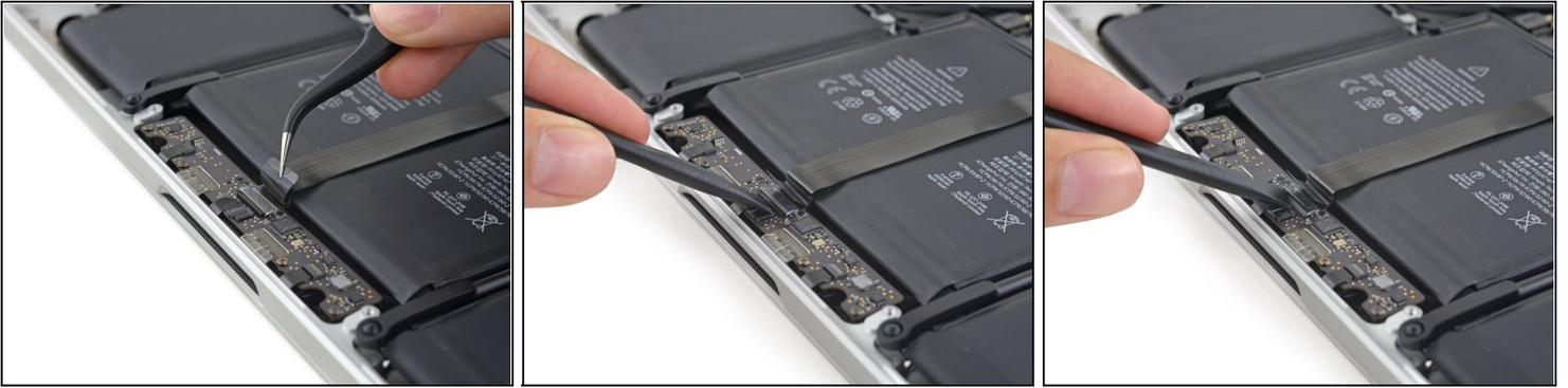
ⓘ Si nécessaire, décollez toute bande adhésive recouvrant le connecteur de la nappe du pavé tactile.
