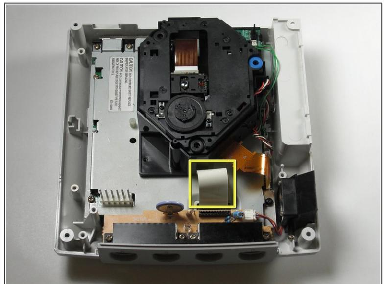
**⚠** Allez y doucement avec le câble de contrôle blanc car il peut être un peu fragile.
