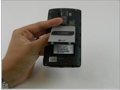
Placez l'outil d'ouverture en plastique en bas de la batterie et soulevez. Retirez délicatement la batterie à la main.
