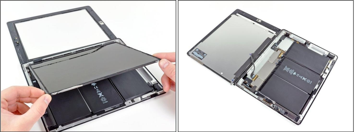
ⓘ Les nappes du panneau frontal sont connectées sous le LCD. Pour y accéder, vous devrez ouvrir et rabattre temporairement le LCD sur le côté.
