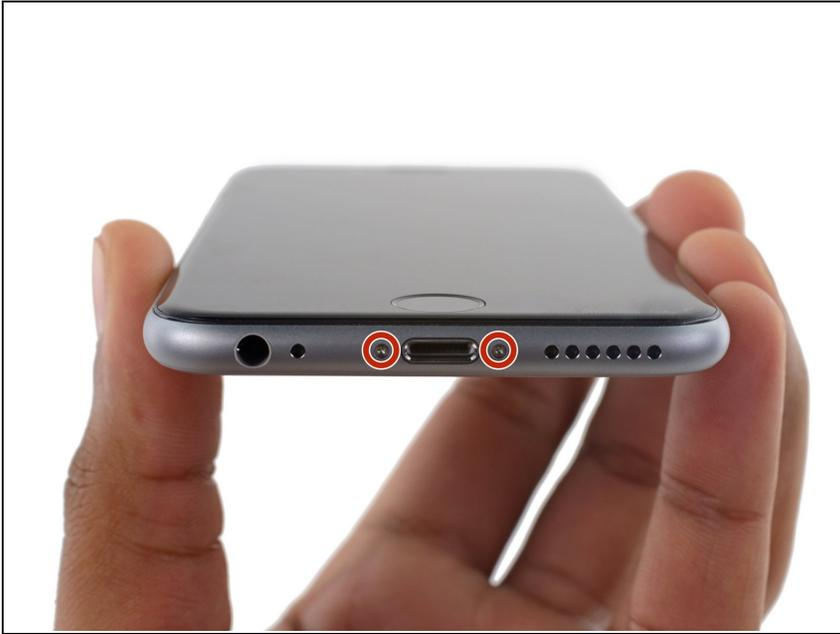
**⚠** Avant de démonter votre iPhone, déchargez la batterie en dessous de 25%. Une batterie lithium-ion chargée peut prendre feu et / ou exploser si elle est accidentellement percée.
