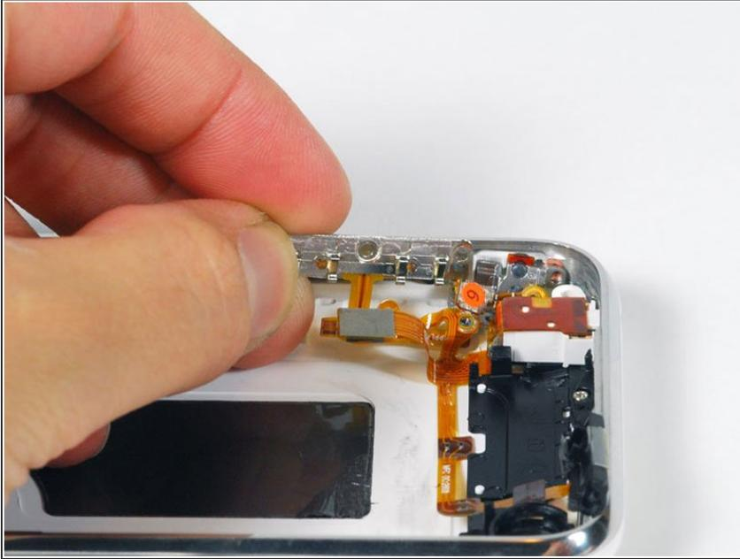
**⚠** Dégagez le circuit du bouton de volume sur le côté de l'iPhone et décollez soigneusement la nappe orange du boîtier arrière. La nappe est fine et très fragile.
