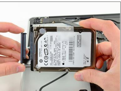
• Retirez le câble du disque dur en débranchant son connecteur du disque dur.
