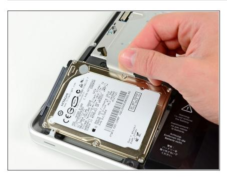
Soulevez le disque dur en tirant sur sa languette d'extraction et sortez-le du châssis, en faisant attention au câble qui le relie à l'ordinateur.
