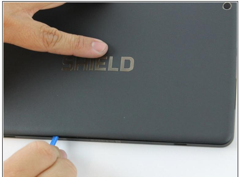
Des clips maintiennent le panneau arrière au reste du boîtier. Vous devez appliquer une force pour soulever le panneau arrière.
