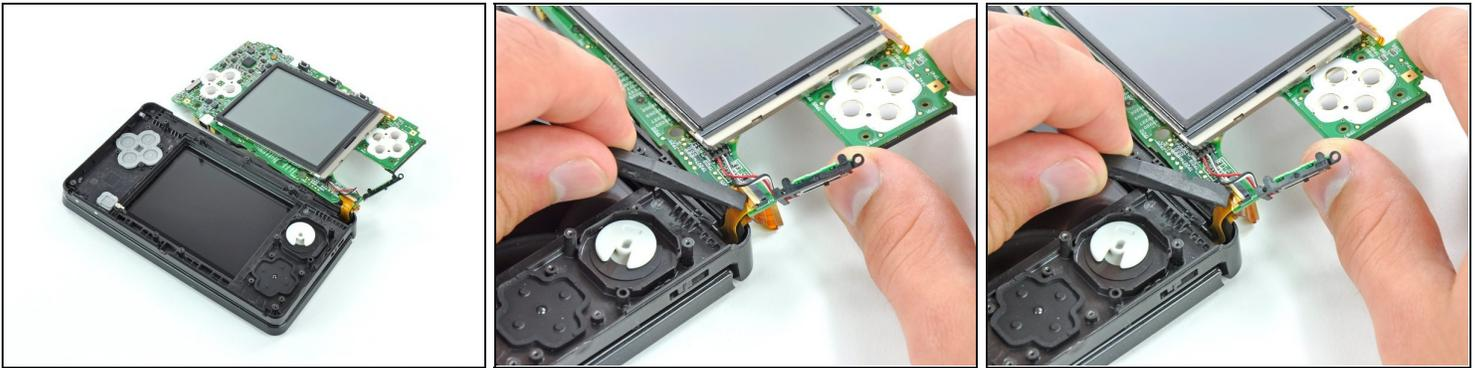
① Continuez à soulever l'ensemble carte mère et faites-le pivoter jusqu'à ce qu'il repose à côté du reste de l'appareil.
