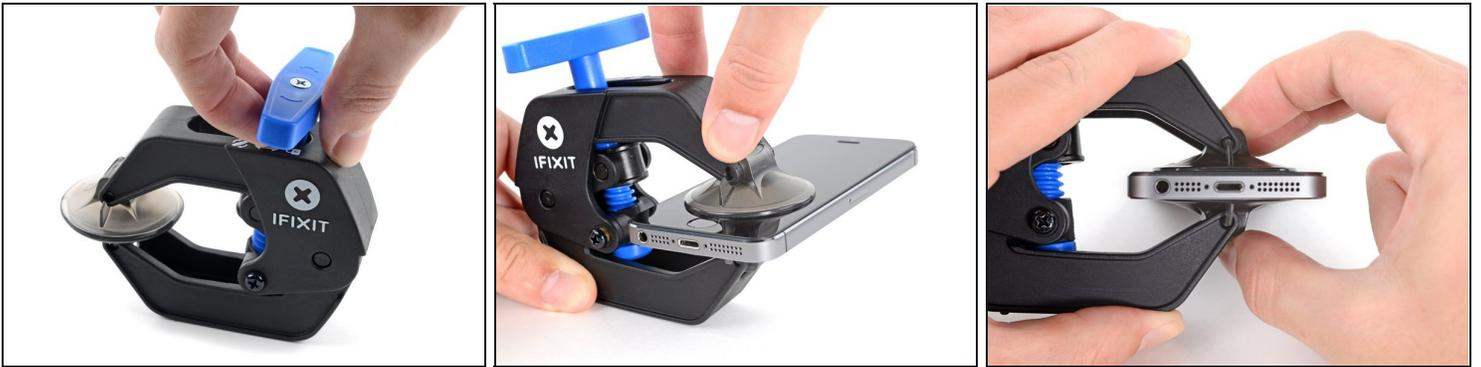
ⓘ Les deux étapes suivantes montrent comment utiliser l'Anti-Clamp, un outil conçu pour faciliter la procédure d'ouverture. **Si vous n'utilisez pas l'Anti-Clamp, sautez ces deux étapes pour une autre méthode.**
