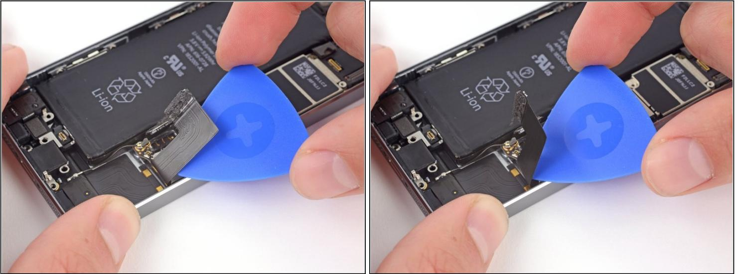
① La nappe de données du connecteur de charge est collée avec de l'adhésif léger au boîtier arrière.
