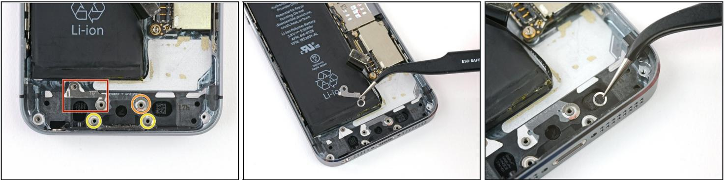
ⓘ Plusieurs petites rondelles assez lâches se trouvent avec les vis sous l'ensemble Lightning. Bien qu'elles ne soient pas essentielles au bon fonctionnement du téléphone, veuillez les remettre à leur place lors du remontage. Ces rondelles varient selon les téléphones, ce modèle comporte les suivantes :
