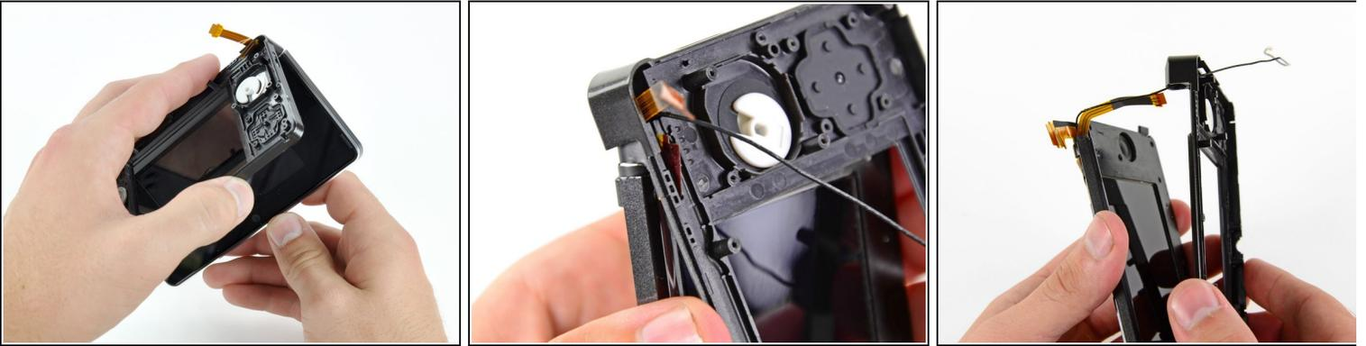
**⚠** Avant de continuer, notez comment les nappes sont orientées (dans quelle direction les contacts dorés sont orientés) et superposées (quelle nappe est au-dessus de laquelle). Les nappes sont trop courtes pour atteindre leurs connecteurs si elles sont placées dans une autre position.
