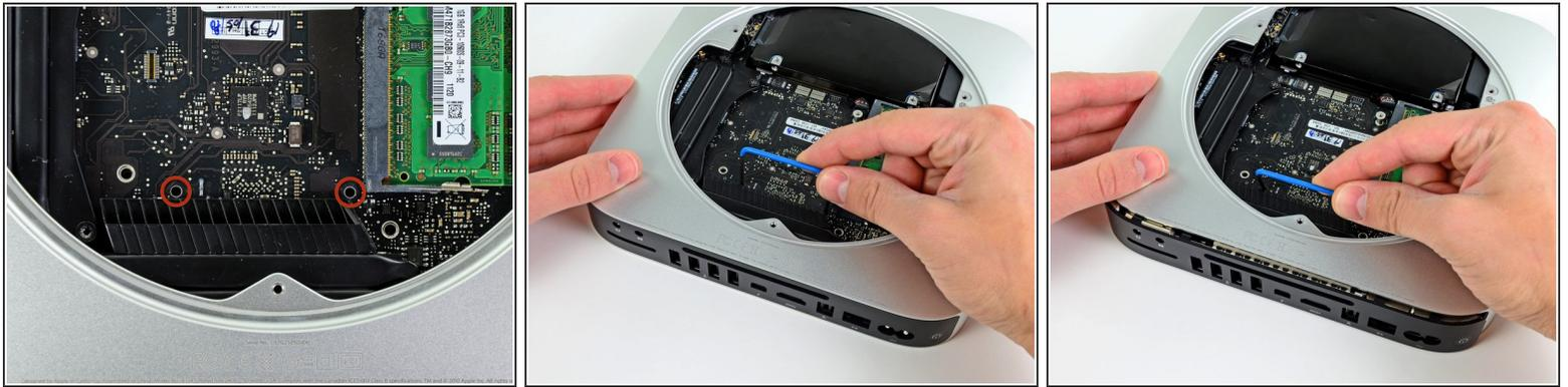
**⚠** Pour le retrait de la carte mère, les deux tiges cylindriques de l'outil de retrait de la carte mère du Mac Mini doivent être insérées dans les orifices repérés en rouge. Attention ! Si vous insérez des instruments dans des orifices de la carte mère autres que ceux repérés en rouge, vous risquez de détruire la carte mère.
