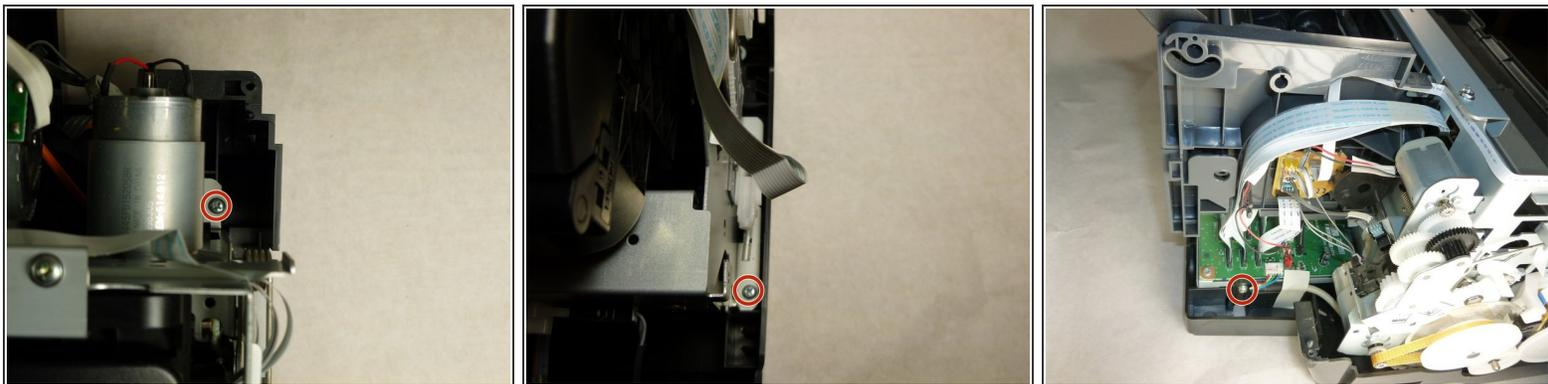
**i** Six vis fixent le mécanisme de l'imprimante.
