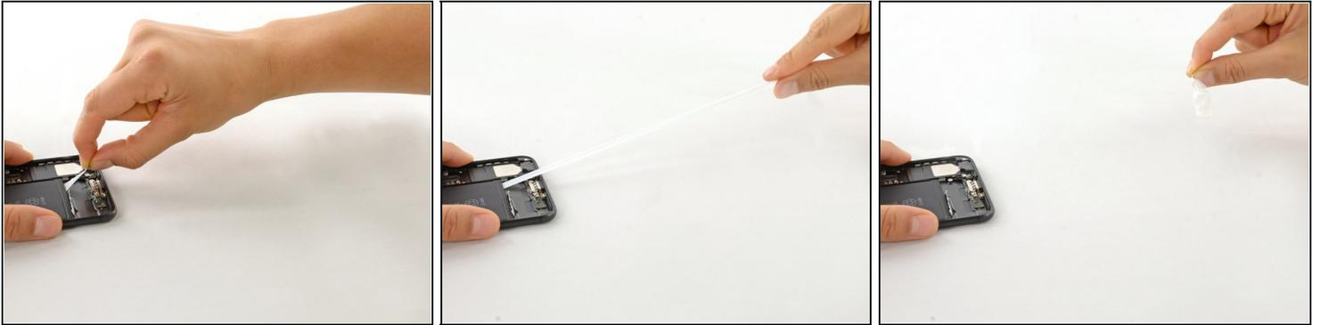
**⚠** Essayez de garder les bandes plates et sans plis durant cette procédure, car des bandes plissées colleront ensemble et se déchireront au lieu de s'enlever proprement.
