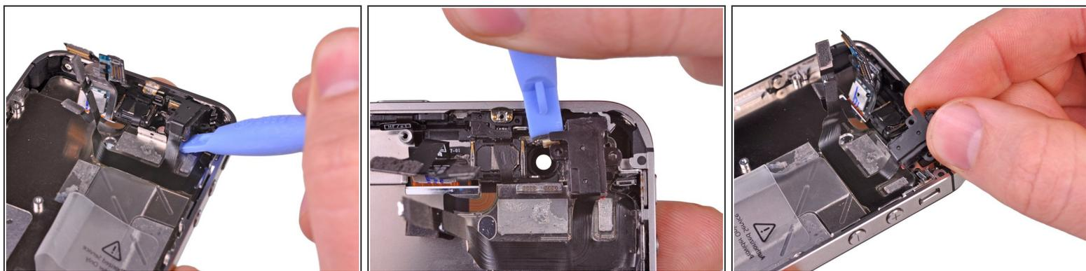
**⚠** Au cours de cette étape, veillez à ne pas retirer la prise casque avant d'avoir ôté le microphone supérieur du boîtier supérieur, car ils sont connectés par un câble flexible fragile.
