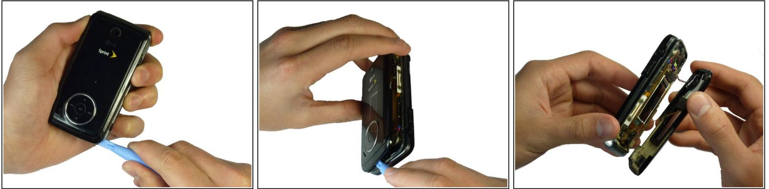
**⚠ Attention:** Il y a des fils et le ruban relie le boîtier avant au corps principal. Faites preuve d'attention lors de la séparation du boîtier avant du corps principal pour ne pas rompre les connexions.
