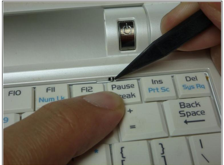
**⚠ Attention** Suivez cette étape pour détacher la partie supérieure du clavier, mais ne le retirez pas de l'ordinateur portable. Vous risqueriez d'endommager le câble plat si il est retiré de façon incorrecte.
