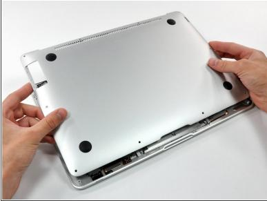
Soulevez légèrement le boîtier inférieur du côté de l'aération et poussez-le vers l'arrière de l'ordinateur pour décrocher les attaches.
