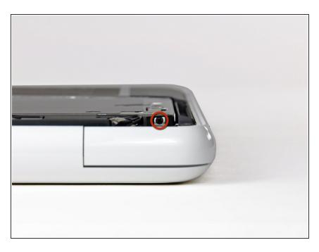
Retirez la vis Phillips 2,2 mm insérée horizontalement à l'intérieur du lecteur optique.
