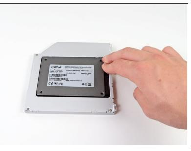
Une fois le disque dur en place, réinsérez la cale en plastique tout en maintenant le disque dur contre le bas du boîtier.
