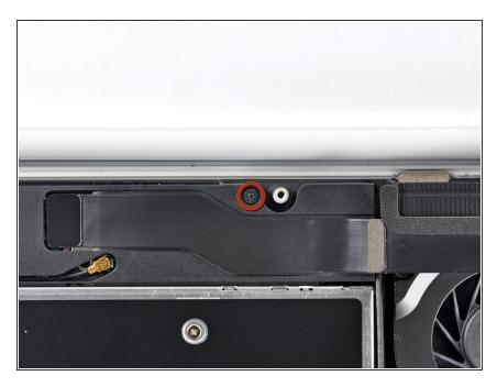
Retirez la vis Phillips 12 mm par laquelle le haut de l'enceinte arrière est fixé au boîtier supérieur.
