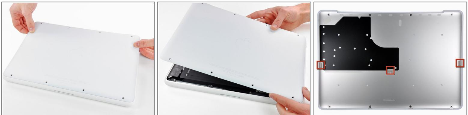
**⚠** Le boîtier inférieur est construit en aluminium avec un revêtement en caoutchouc. Ne pliez pas trop l'aluminium lors du retrait, car une déformation permanente générerait des problèmes de tolérance après le remontage.
