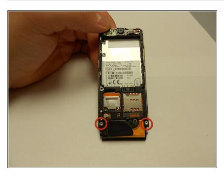
À l'aide d'un tournevis T5, desserrez et retirez les deux vis en les tournant dans le sens inverse des aiguilles d'une montre.
