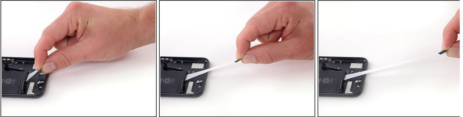
**⚠** Essayez de garder les bandes plates et sans plis durant cette procédure, car des bandes plissées colleront ensemble et se déchireront au lieu de s'enlever proprement.
