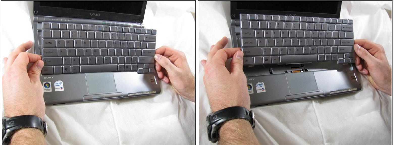
**⚠** Ne retirez pas le clavier de l'ordinateur portable. Il y a une nappe de connexion qui maintient le clavier à l'ordinateur.
