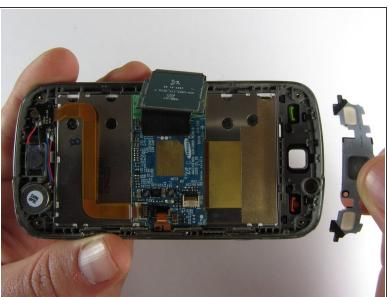
Dans cette procédure, le clavier de fonction en caoutchouc peut facilement tomber, il est donc préférable de le sortir et de le mettre de côté en toute sécurité.
