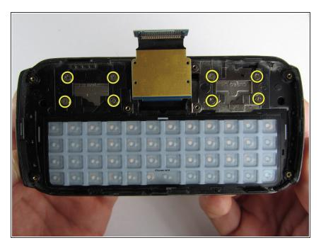
Retirez les huit vis Philips de 1,7 mm au-dessus du clavier.
