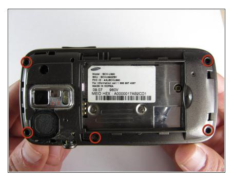
Retirez les cinq vis Philips de 3,4 mm fixant le support du téléphone.
