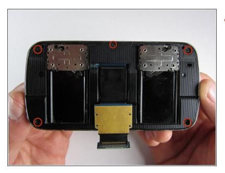
Retirez les cinq vis Philips de 3,0 mm autour de l'extérieur des mécanismes coulissants.
