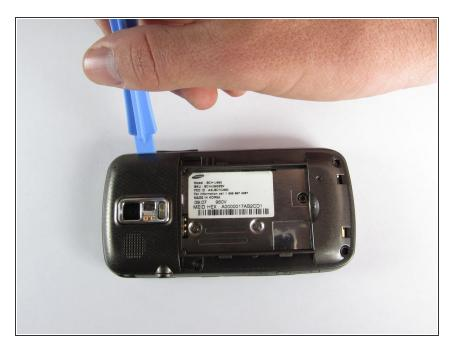
Utilisez un outil d'ouverture en plastique pour soulever délicatement le couvercle arrière entourant la caméra du téléphone.
