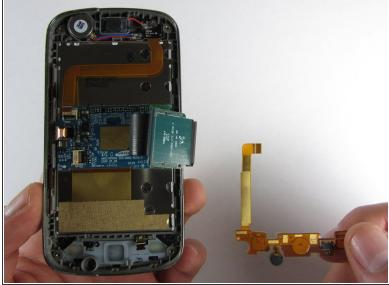
• À l'aide d'une pince à épiler, retirez délicatement la bande orange inférieure de l'appareil
