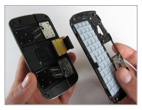
Retirez délicatement le cadre du clavier des mécanismes coulissants en dessous.
